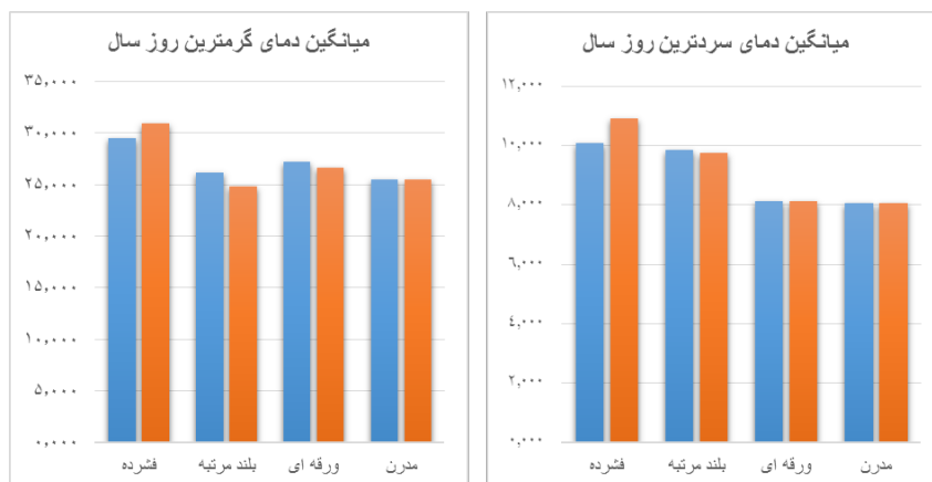
نمودار ۹ و ۱۰: مقایسه مقدار میانگین دمای هوا وضعیت موجود با شرایط پیشنهادی در گرمترین و سردترین روز سال
