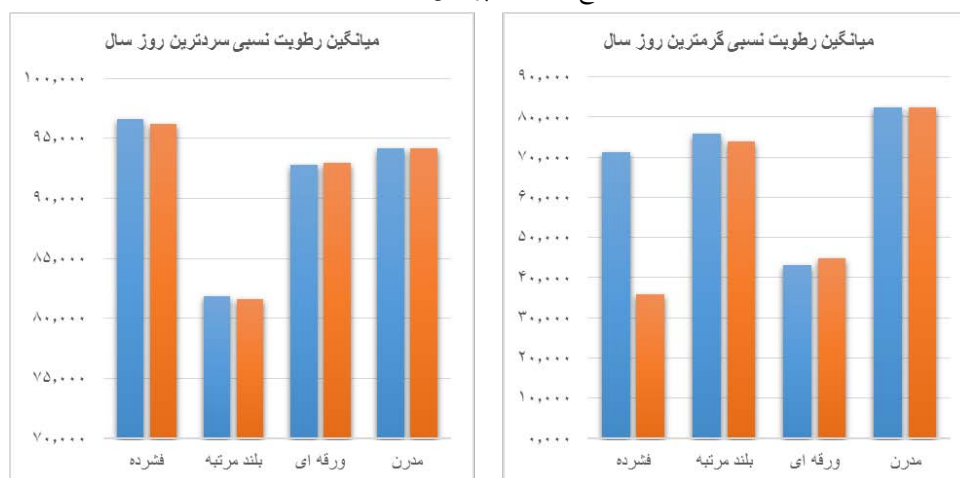
نمودار ۱۳ و ۱۴: مقایسه مقدار میانگین رطوبت نسبی وضعیت موجود با شرایط پیشنهادی در گرمترین و سردترین روز سال
