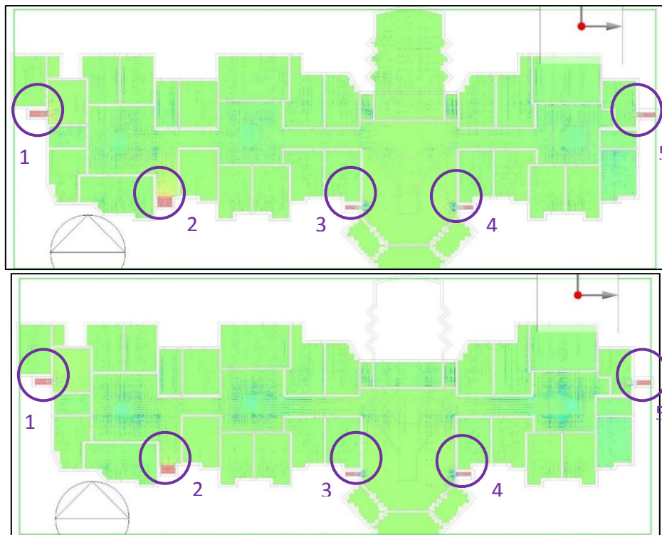
تصاویر ۱۶ و ۱۷. توزیع دمایی طبقات همکف و اول ساختمان با اعمال دودکش خورشیدی با روش دینامیک
