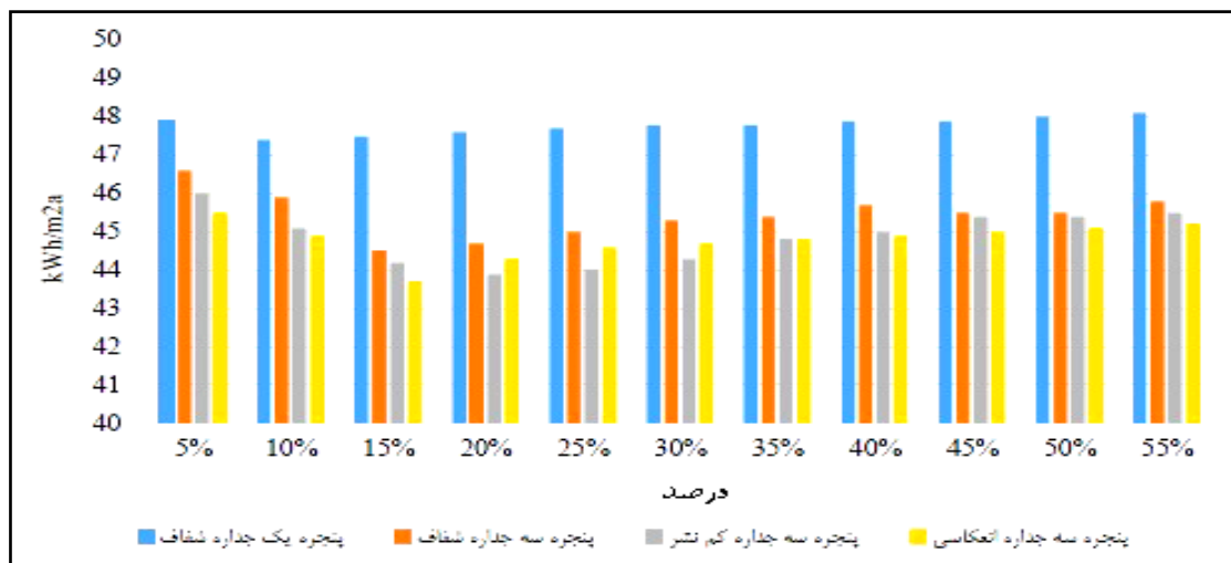
شکل ۶. نمودار میزان مصرف انرژی کل ساختمان منطقه ۱۲ با نوع و نسبت مختلف مساحت پنجره در تمام
