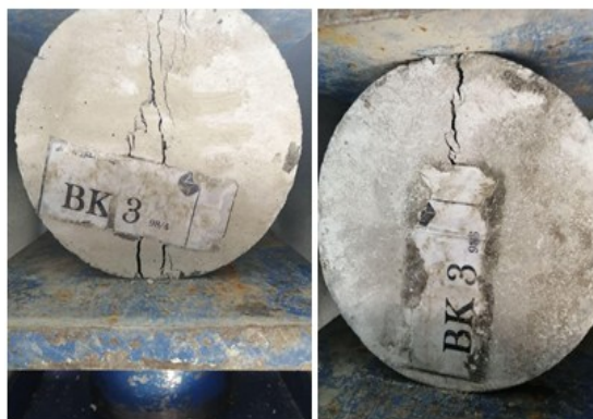
شکل (۵): مقاومت کششی به روش برزیلی در نمونه‌های استوانه‌ای منبع: نگارندگان، ۱۴۰۰
