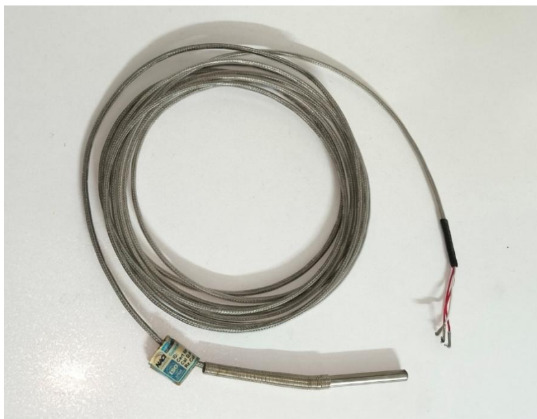
شکل ۳- حسگرهای دمای PT100 مورد استفاده برای اندازه‌گیری دمای سیال و خاک
