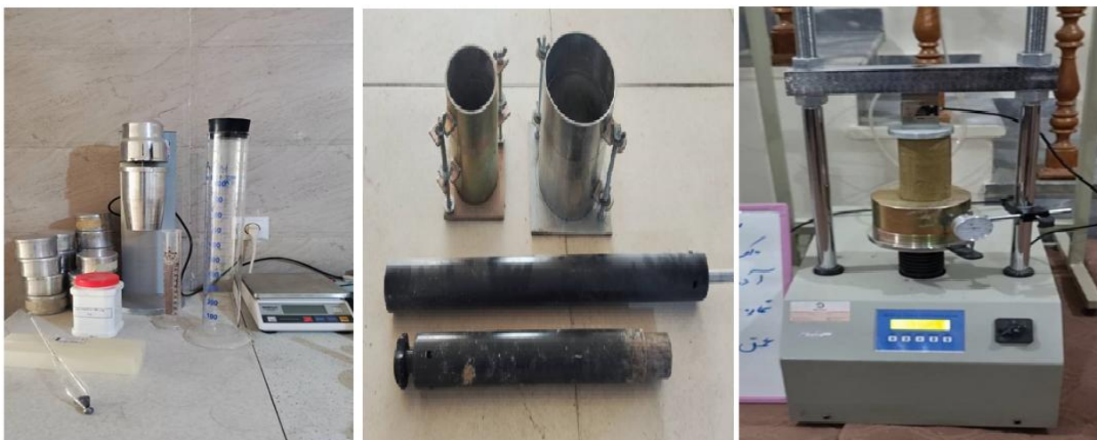
ح دستگاه مقاومت فشاری تک‌محوری به همراه نمونه خاک ب لوازم و تجهیزات آزمایش تراکم به روش استاندارد الف بندی به روش هیدرومتری لوازم آزمایش دانه
